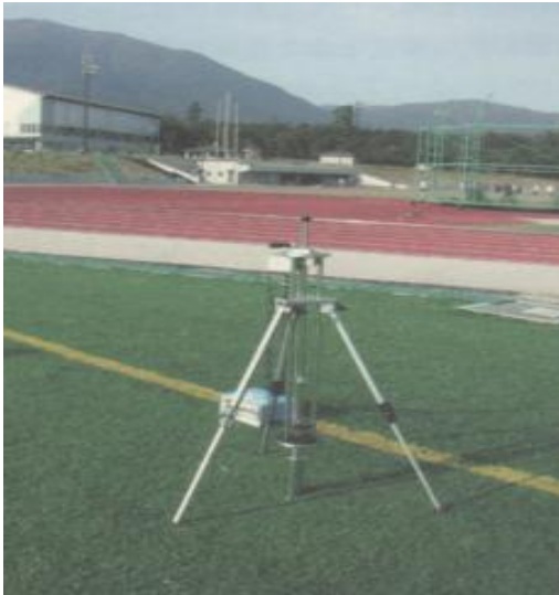
写真 7. 使用した衝撃試験機 (文献 10 より掲載)
